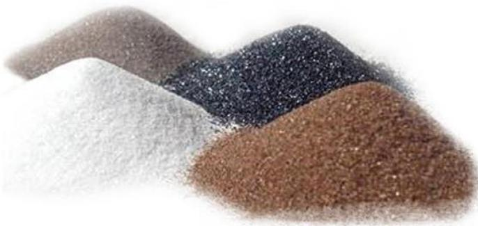
A maioria dos abrasivos são fabricados artificialmente por processos industriais. Óxido de alumínio e carbureto de silício são abrasivos convencionais.
